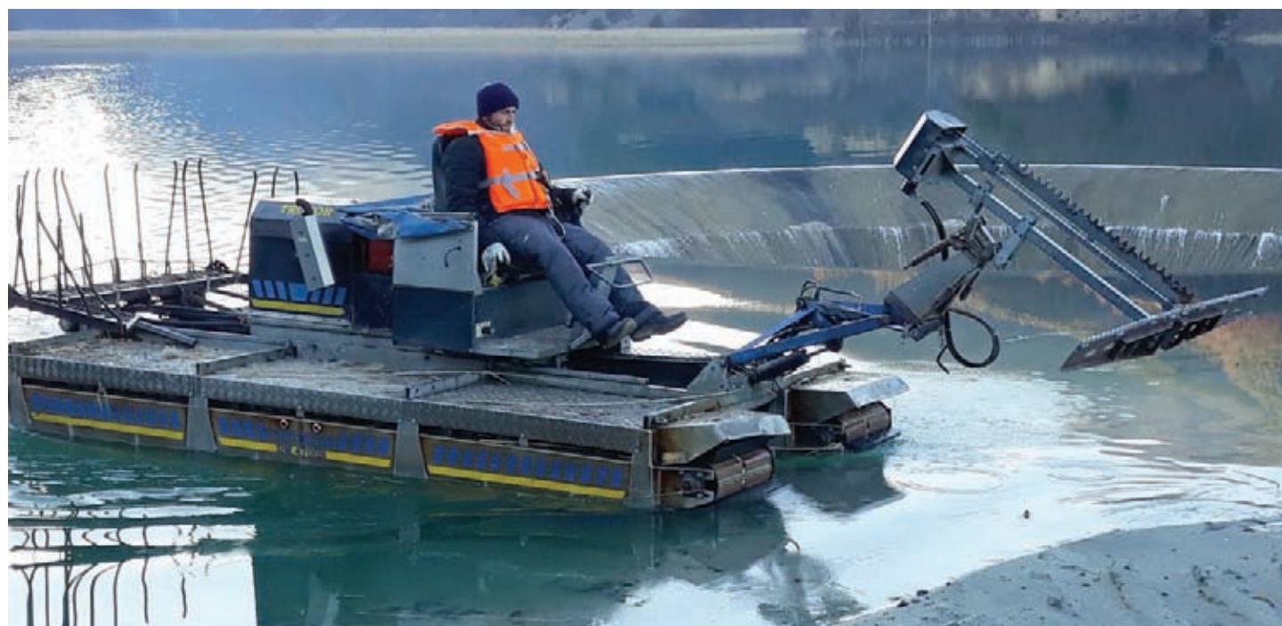
Иновативна технология за косене на тръстика в утаечното езеро на хвостохранилище „Ерма река“ с многофункционална самоходна машина-амфибия.
