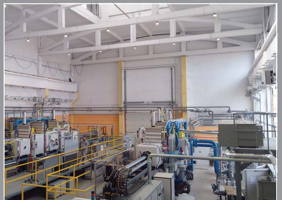
С уникалното оборудване ще се извършва термозащитно покритие върху метални компоненти.
